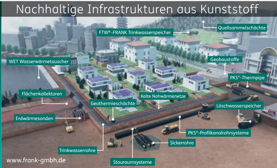
Labels in the image: Quellsammelschächte, FTW®-FRANK Trinkwasserspeicher, Geobaustoffe, WET Wasserwärmetauscher, Flächenkollektoren, Erdwärmesonden, Geothermieschächte, Kalte Nahwärmenetze, Löschwasserspeicher, PKS®-Thermpipe, PKS®-Profilkanalrohrsysteme, Sickerrohre, Trinkwasserrohre, Stauraumsysteme.
