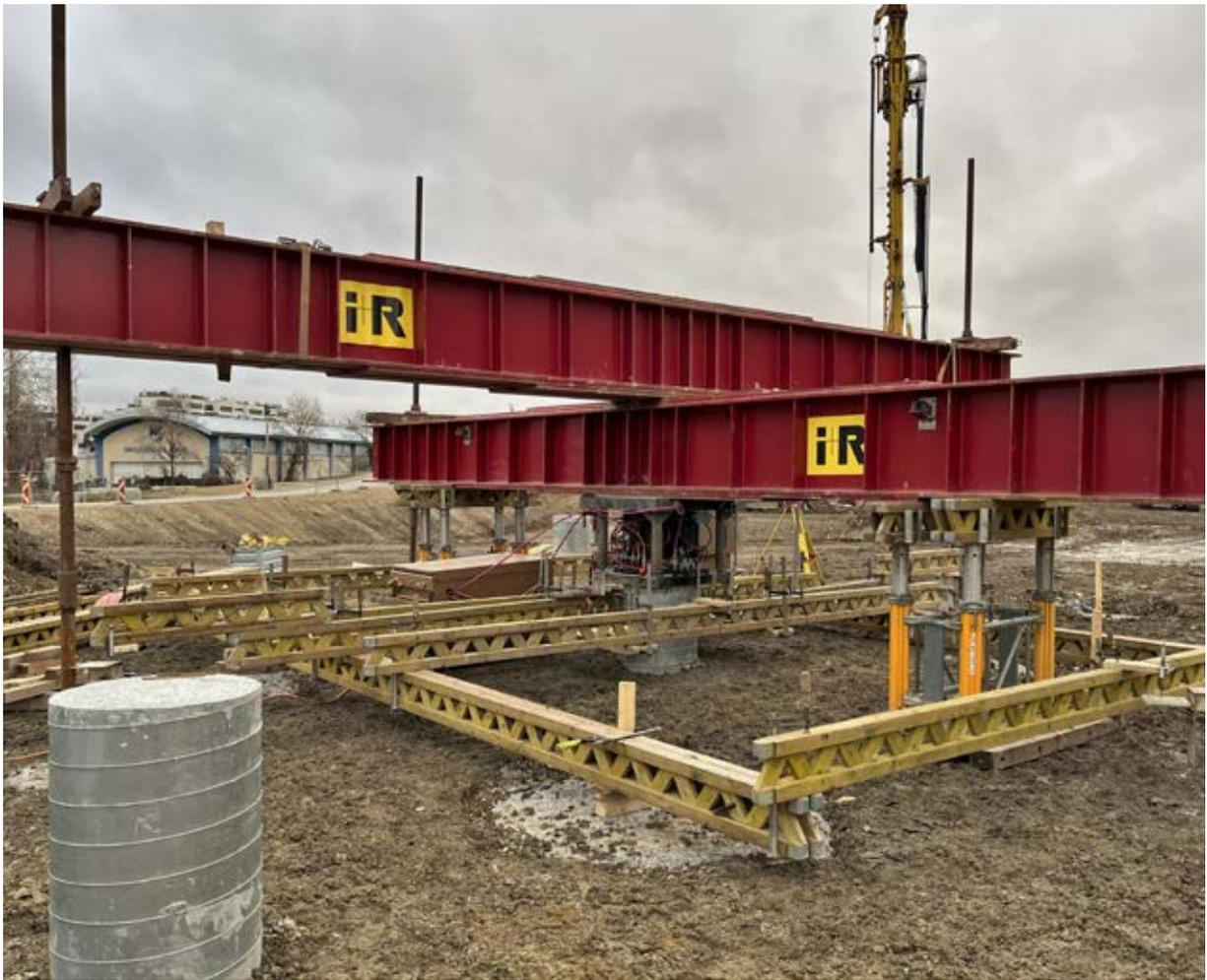
Abb. 3: Statische Probelastung für das Value Engineering auf dem Baufeld BF 08
