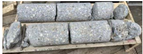
Abbildung 7: Herstellung Kernbohrung, gekernter Bohrpfahl D120 cm
