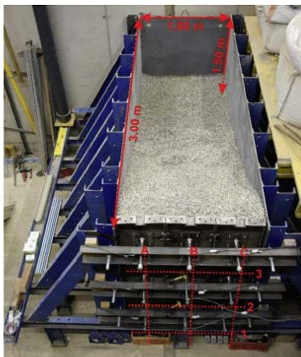
Abb. 3: Versuchsaufbau während der Hinterfüllung
