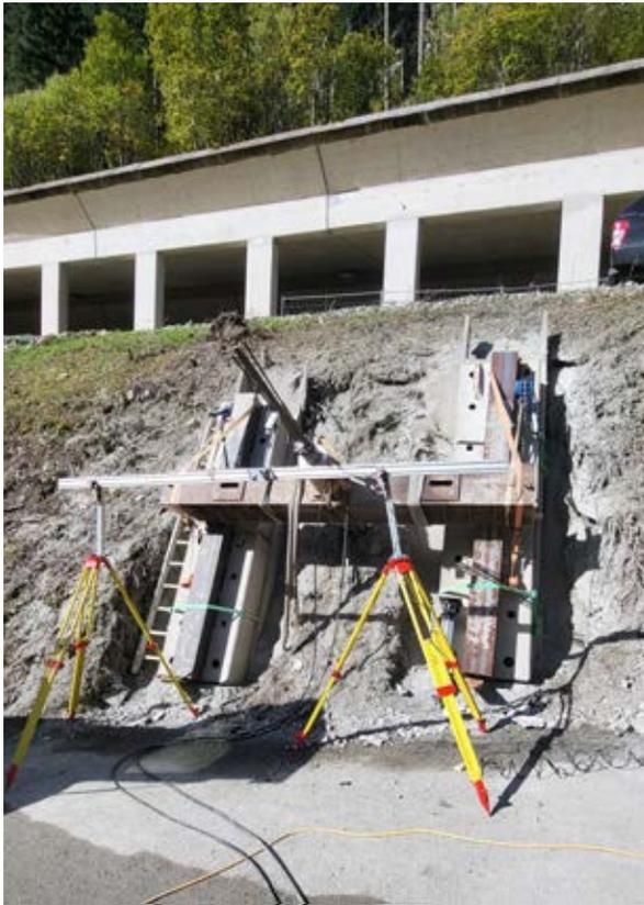
Prüfereinrichtung der Systemprüfung mit Prüflasten bis zu 1.300kN [2]
