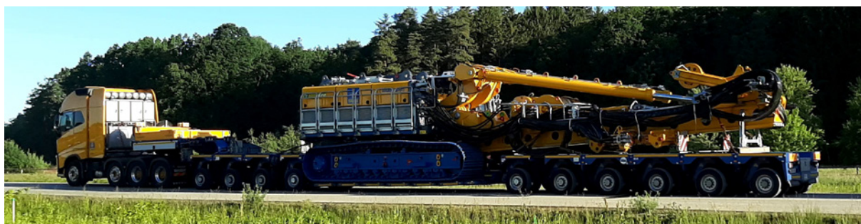
BAUER BG 45 in abgebautem Zustand auf dem Schwertransport
